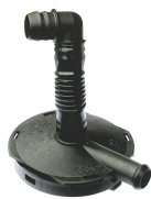
VÁLVULA ANTICHAMA DE VENTILAÇÃO DO CARTER
