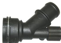
**CONEXÃO INFERIOR DO RADIADOR**
